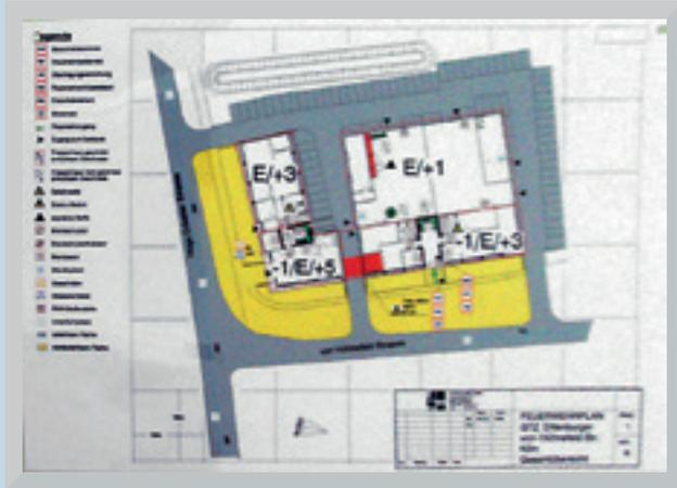
(FEP) nach DIN 14095 bzw. an die spezifischen Wünsche der zuständigen Feuerwehr angepasst.
